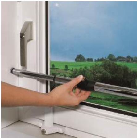
Abbildung 5: Abschließbare Teleskopstange zum Blockieren von Fenstern und Fenstertüren mit Verankerung in der Mauerleibung; erlaubt Kippöffnung (Foto: © ABUS August Bremicker Söhne KG)
